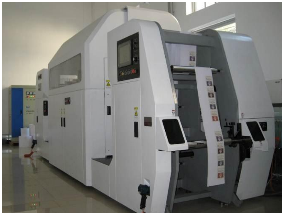
高速喷墨印刷系统(水性喷墨，健康环保)
